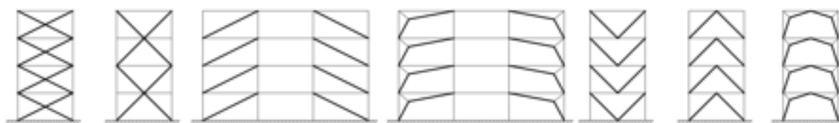
Figura B.6.4. Sisteme constructive cu contravântuiri centrice
